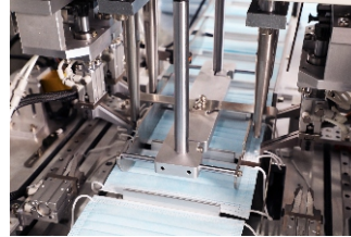
超声波焊接机构 Ultrasonic mechanism
